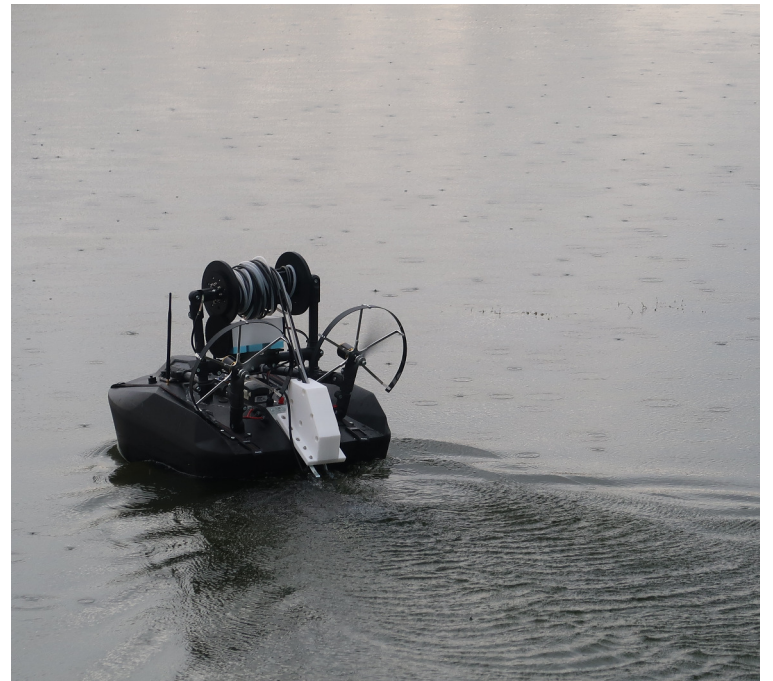
Le drone nautique réalise des prélèvements qui sont analysés sur place, à l'aide d'un simple microscope.
