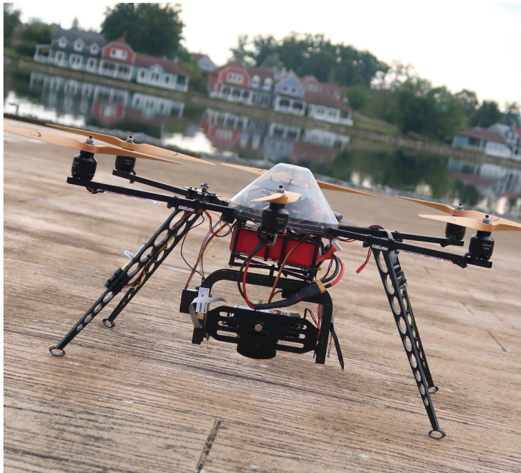
La caméra du drone aérien est capable de détecter le bleu-vert que donnent les cyanobactéries à l'eau.
